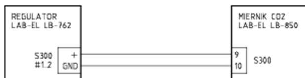
Рисунок 3.4. Схема подключения измерителя типа LAB-EL LB-850
