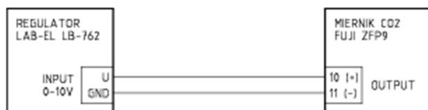
Рисунок 3.3. Схема подключения измерителя типа FUJI ZFP9
