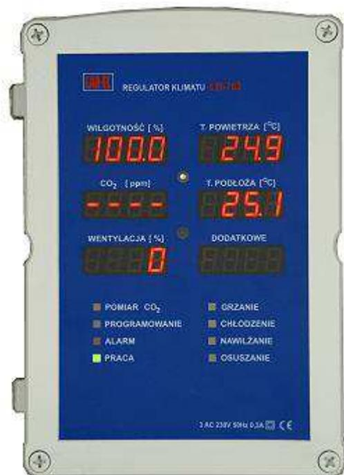
Рисунок 2.1. Лицевая панель регулятора LB-762
