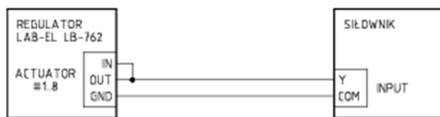
Рисунок 3.9. Схема подключения аналогового привода без сигнала обратной связи
