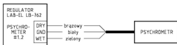
Рисунок 3.1. Схема подключения психрометра
