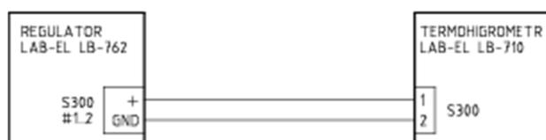
Рисунок 3.5. Схема подключения измерителя типа LAB-EL LB-710
