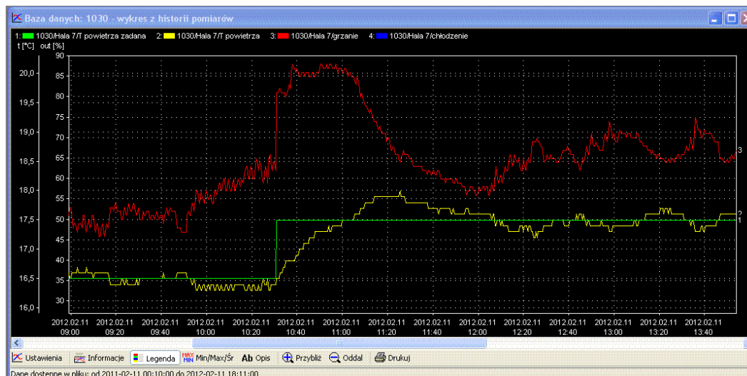
Rys. 4. Rzeczywista regulacja po zestrojeniu PID grzania.
